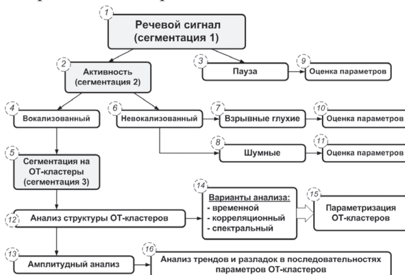
Рис. 1. Этапы сегментации и параметризации речевого сигнала
