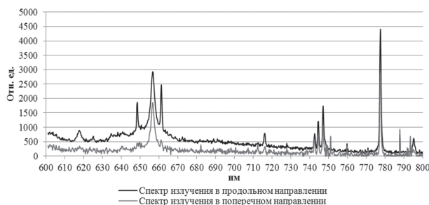
Рис. 2. Спектр излучения плазменного факела; рабочее вещество – воздух; 600–800 нм
