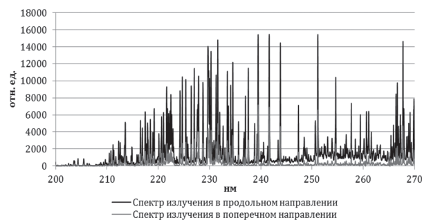
Рис. 4. Спектр излучения плазменного факела в ультрафиолетовой области; рабочее вещество – воздух + пары воды и бензина; 200–270 нм
