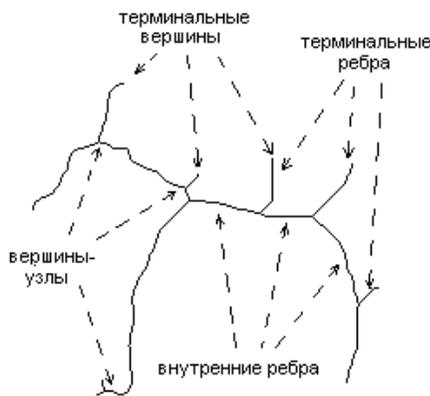
Рис. 2. Скелет бинарного изображения: сплошными линиями обозначен скелет, пунктирными со стрелками – указатели на элементы скелета
