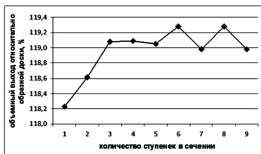
Рис. 8. Зависимость объема партии ступенчатых заготовок от количества ступенек
