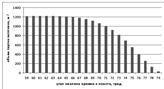
Рис. 7. Зависимость объемного выхода партии трапецидальных заготовок от единого угла наклона кромки к пласти
