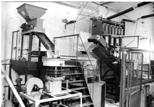
Рис. 5. Комплексная установка для дезинтеграции и выделения ограночного кристаллосырья (на испытательном стенде в КНЦ РАН)
