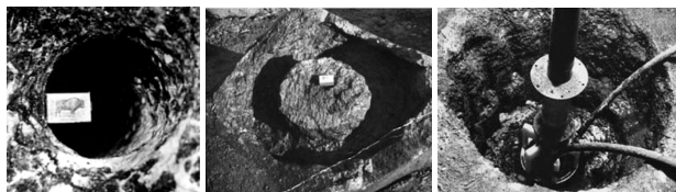
Рис. 2. Устройства электроимпульсного бурения и вид пробуренных скважин
