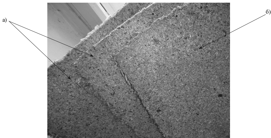
Рис. 2. Образцы ДСП: а) без наполнителя в связующем; б) с НШН в связующем
