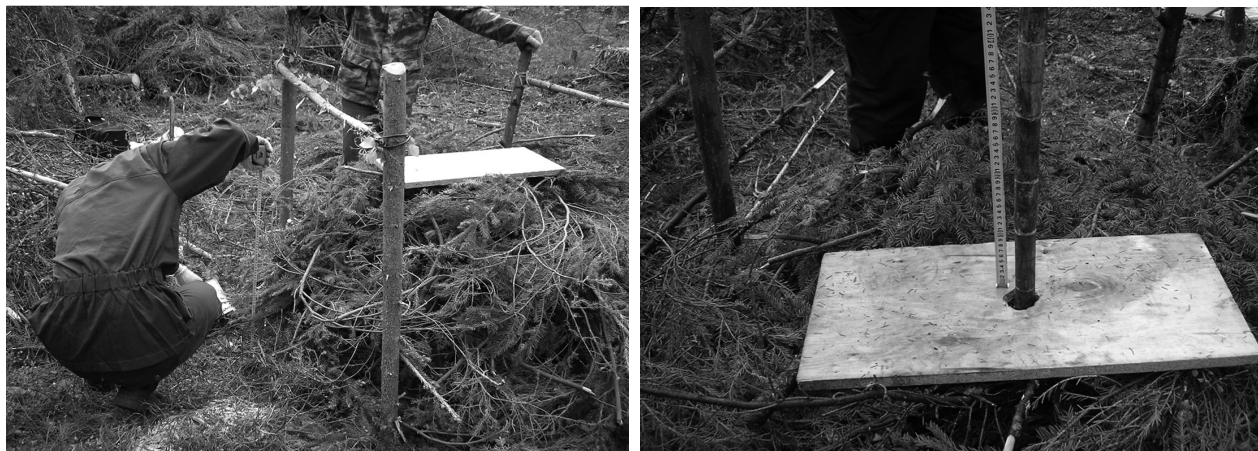
Рис. 1. Полевые исследования упругих свойств покрытия волока
