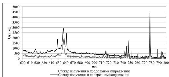
Рис. 2. Спектр излучения плазменного факела; рабочее вещество – воздух; 600–800 нм
