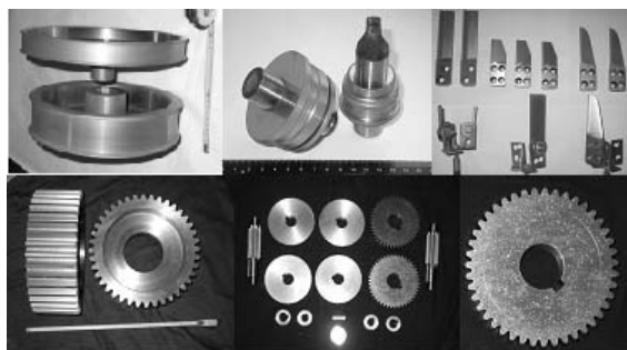
Рис. 7. Фотографии изделий, обработанных по комбинированной технологии (верхний ряд) и азотированных (нижний ряд)
