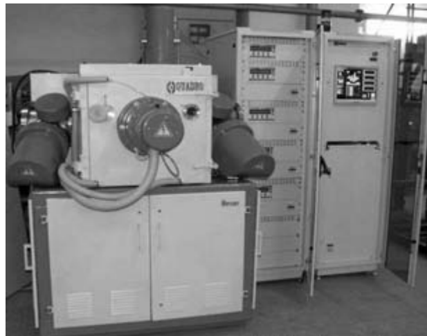
Рис. 3. Общий вид комплексной вакуумной ионно-плазменной установки «КВАДРО»
