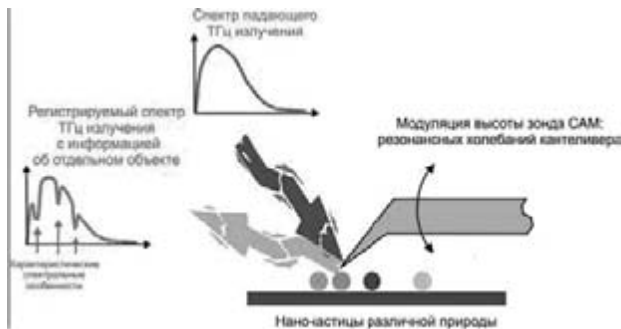
Рис. 4. Схема совмещения ТГц-спектроскопии с атомно-силовым микроскопом
