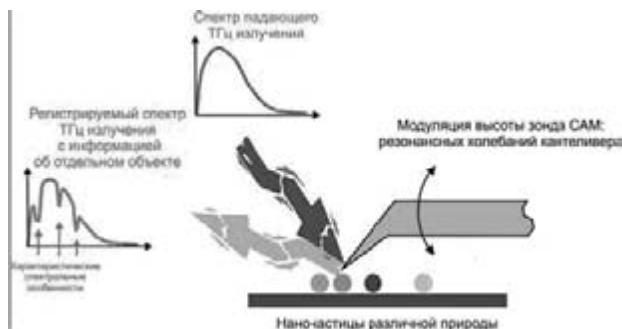
Рис. 4. Схема совмещения ТГц-спектроскопии с атомно-силовым микроскопом
