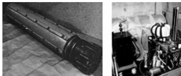
Рис. 7. Источники импульсного напряжения по схеме ИТ, разработки ТФ ВЭИ (слева) и НИИ ЭФА (справа)
