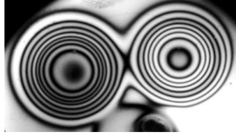
Рис. 5. Интерференционная картина пленок на кремниевой подложке: неон, \lambda = 546 нм, q = 30 Кл, ток 20 мА (слева), q = 30 Кл, ток 5 мА
