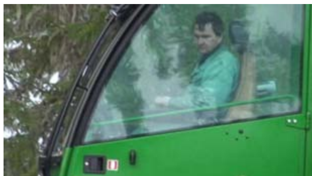
Рис. 4. Неудобные позы при работе на харвестерах без поворотной кабины
