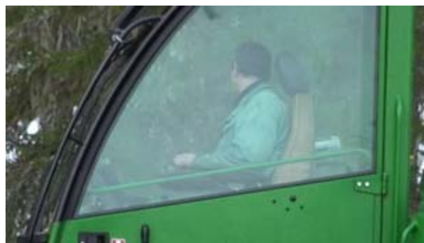
Рис. 4. Неудобные позы при работе на харвестерах без поворотной кабины
