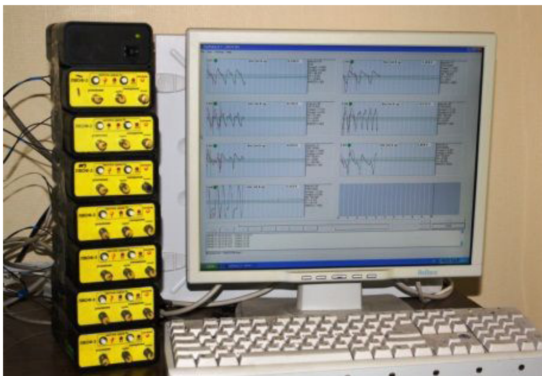
Рис. 2. Установка для многоканальной регистрации кардиоактивности одновременно до 7 животных и интерфейс оригинальной программы «VarPulse»
