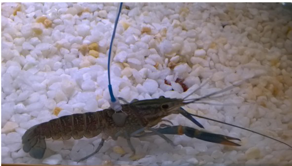
Рис. 1. Красноклешневой рак Cherax quadricarinatus с прикрепленным датчиком для регистрации ЧСС Fig. 1. Red-claw crayfish Cherax quadricarinatus with a fixed sensor
