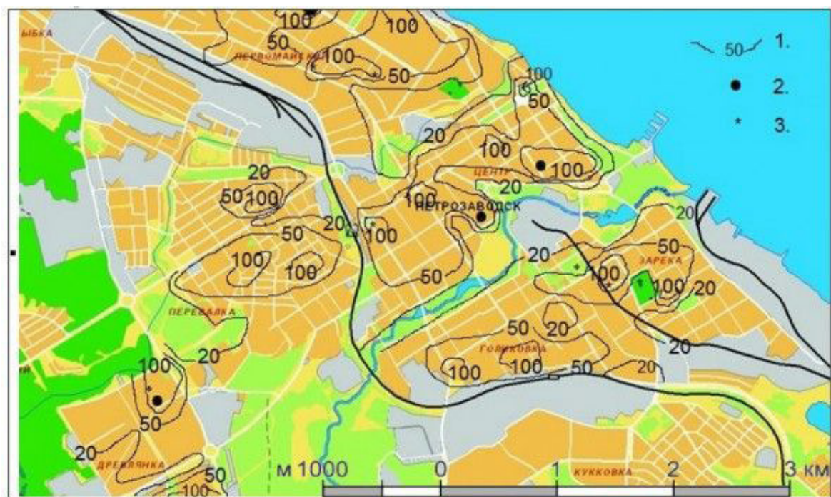
Рис. 2. Схематическая карта значений магнитной индукции в пределах территории г. Петрозаводска. Условные обозначения: 1. Изолинии и их оцифровка, нТл. 2. Аномалии по 3δ пределу. 3. Аномалии по 2δ пределу
