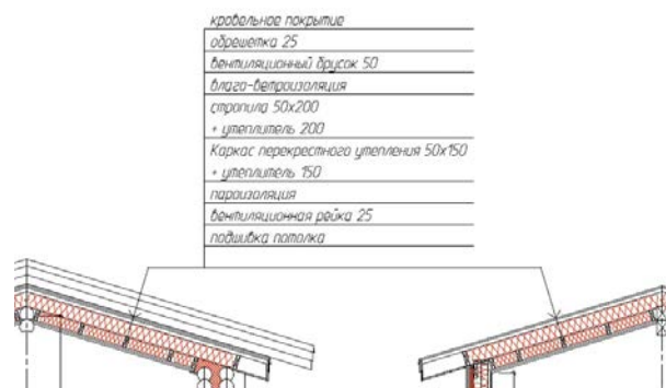
Рисунок 3. Состав структурных слоев конструкции крыши.
