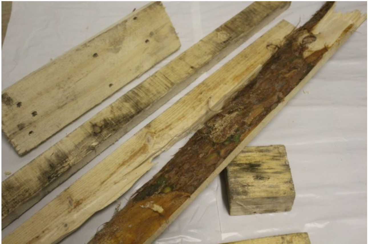
Рис. 2. Элементы древесных упаковочных материалов с признаками повреждений
