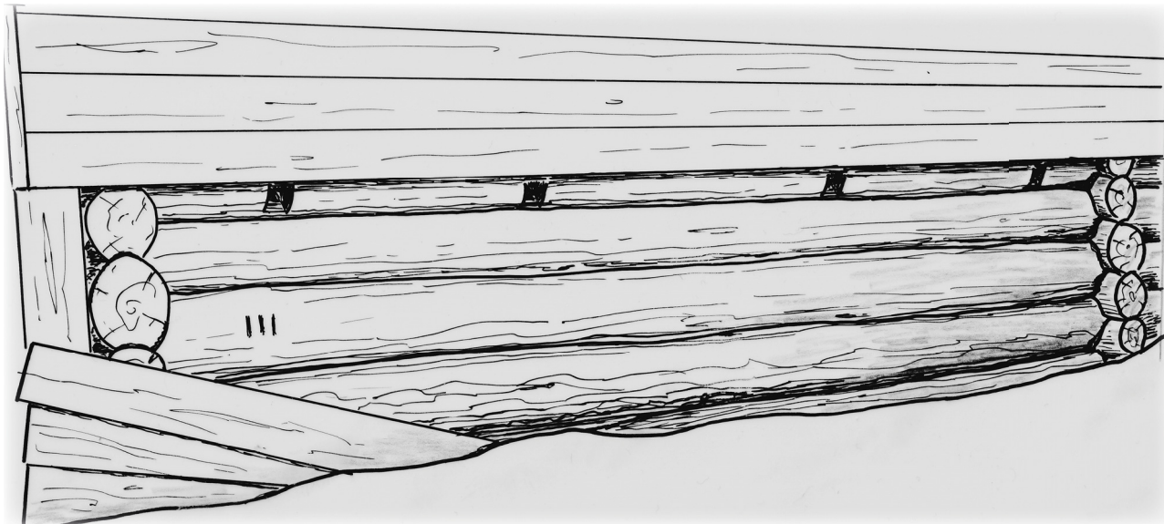
Рис. 8. Гнезда и маркировка, оставшиеся после замены нижних венцов (прорисовка с фото 2022 г.)
