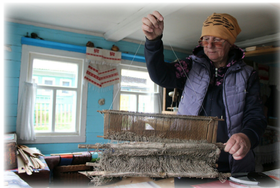
Надежда Сергеевна Семёнова показывает детали ткацкого станка — бёрдо. В «Хламном сарае», Нюхча, фото П. Ворониной
