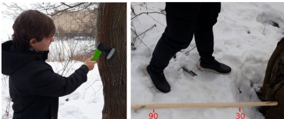
Рис. 4. Отметка дерева затёской и измерение расстояния до ствола
